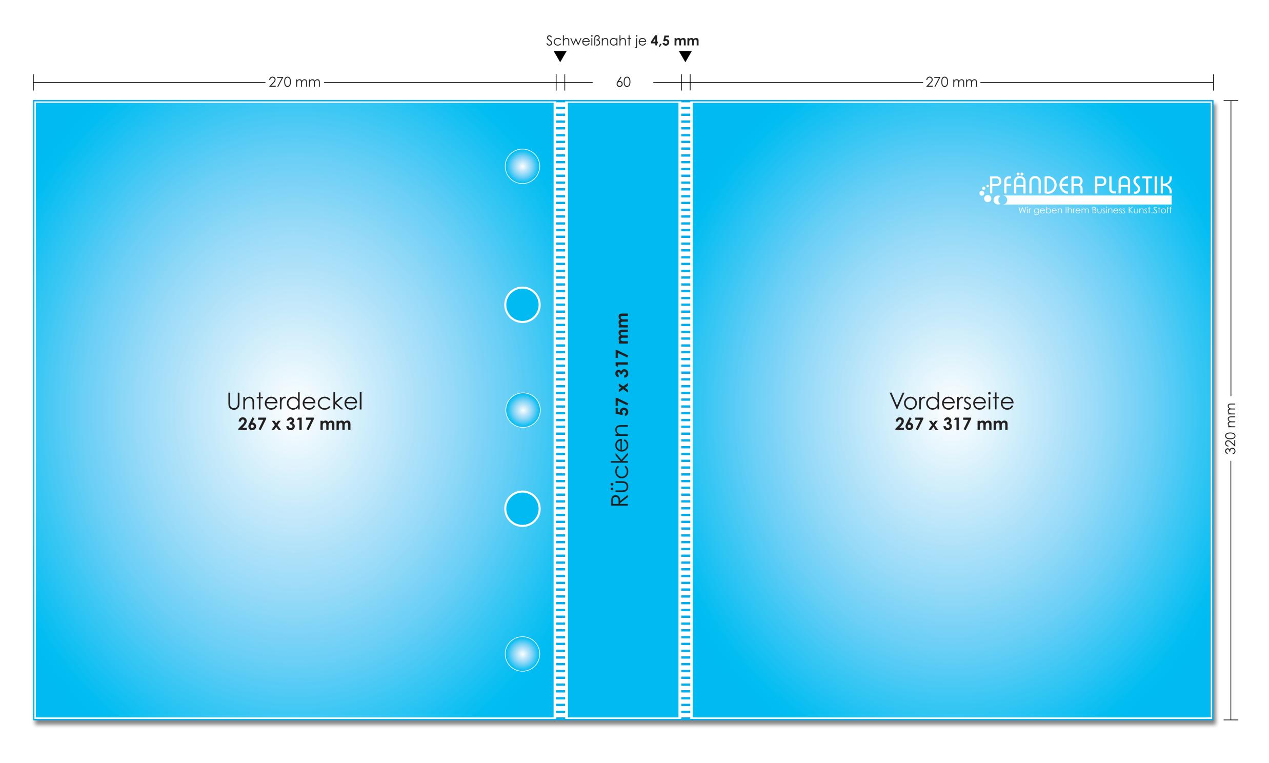
zu gestaltende Offsetdrucksache (180 - 210 g), welche beim Schweißvorgang mit eingelegt werden kann oder nachträglich von oben eingeschoben wird
